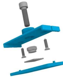
Abb. 3: Aufbau einer Klotzbrückenverstelleinheit
